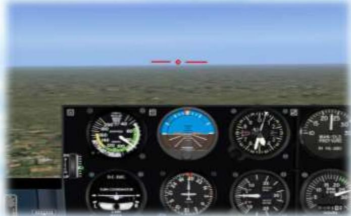
Préparer l'avion pour la descente : Avion stabilisé en configuration atterrissage à 1.6 Vs0
