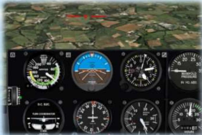
Mise en descente et compensation après réduction de puissance.
