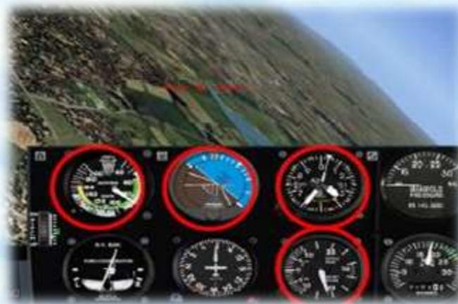
Stabilisation du virage à 45° d'inclinaison à  $V_i$  et  $V_z$  stables.
