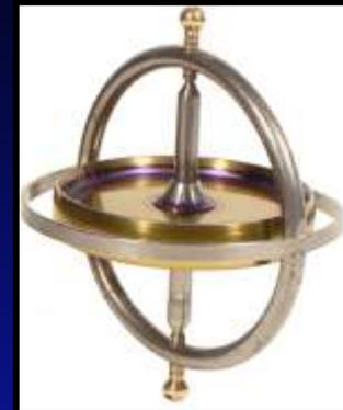
La propriété de fixité des gyroscopes permet de les utiliser comme des plateformes de référence stables, à bord des avions.
