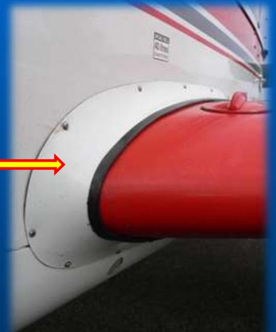
Au saumon de l'aile, on rencontre souvent une pièce verticale dont le rôle est de diminuer la turbulence de sillage, la traînée et d'optimiser l'écoulement des filets d'air.
