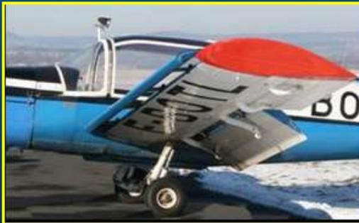
A vitesse élevée les becs sont plaqués contre le bord d'attaque de l'aile et se déploient vers l'avant automatiquement grâce à la dépression locale à incidence élevée. Ces becs sont montés notamment sur les Morane-Saulnier Rallye.
