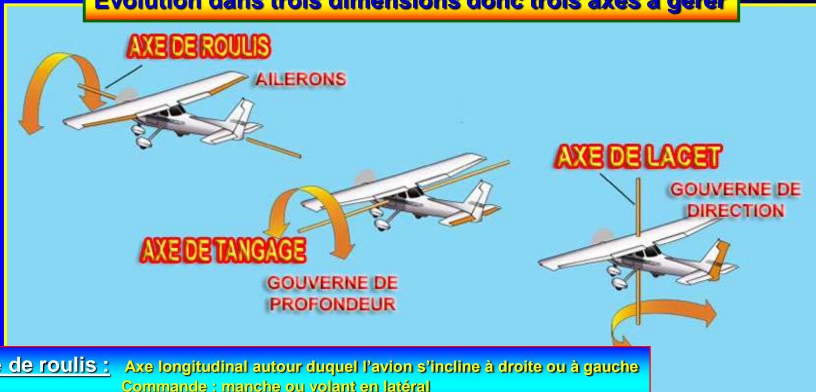
**Axe de roulis :** Axe longitudinal autour duquel l'avion s'incline à droite ou à gauche
